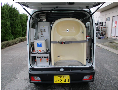
ボイラー、浴槽等搭載
